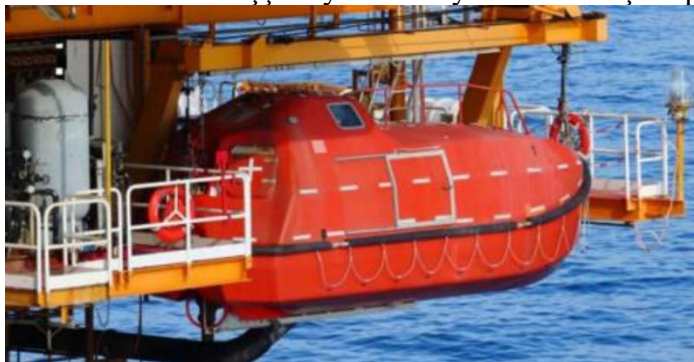
Şəkil 1. Platformadan işçi heyətin təxliyə edilməsi üçün qayıq.
